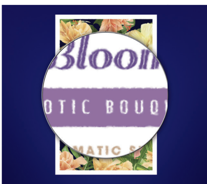
未使用助印剂的印刷效果
